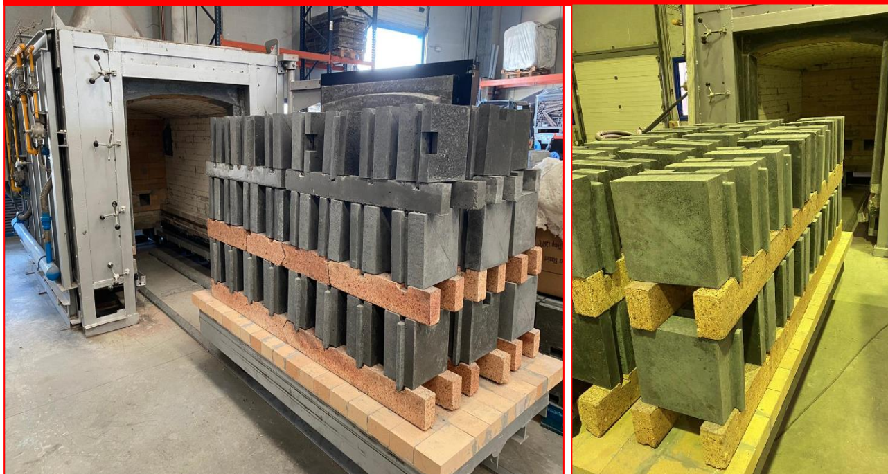
Sinterizado especial automatizado Tratamiento térmico controlado por PLC
