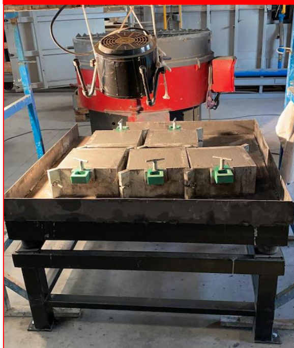
Vertido en moldes y fraguado controlado
