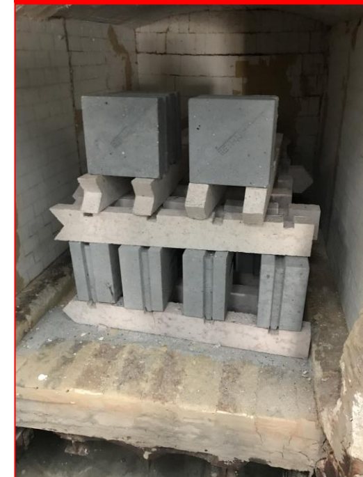
Enfriamiento controlado en horno
